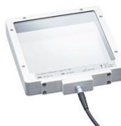
La cámara DAP es la herramienta perfecta para la calibración de campo del DAP. No hay que preocuparse por estimar el tamaño del campo o por las homogeneidades. Simplemente coloque la cámara DAP sobre el haz para obtener un valor DAP preciso.
