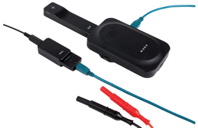
Unidad básica del Mako con Sonda R/F insertada, el módulo mAs conectado y el cable mAs.
