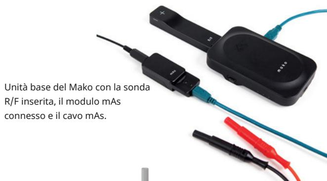
Unità base del Mako con la sonda R/F inserita, il modulo mAs connesso e il cavo mAs.
